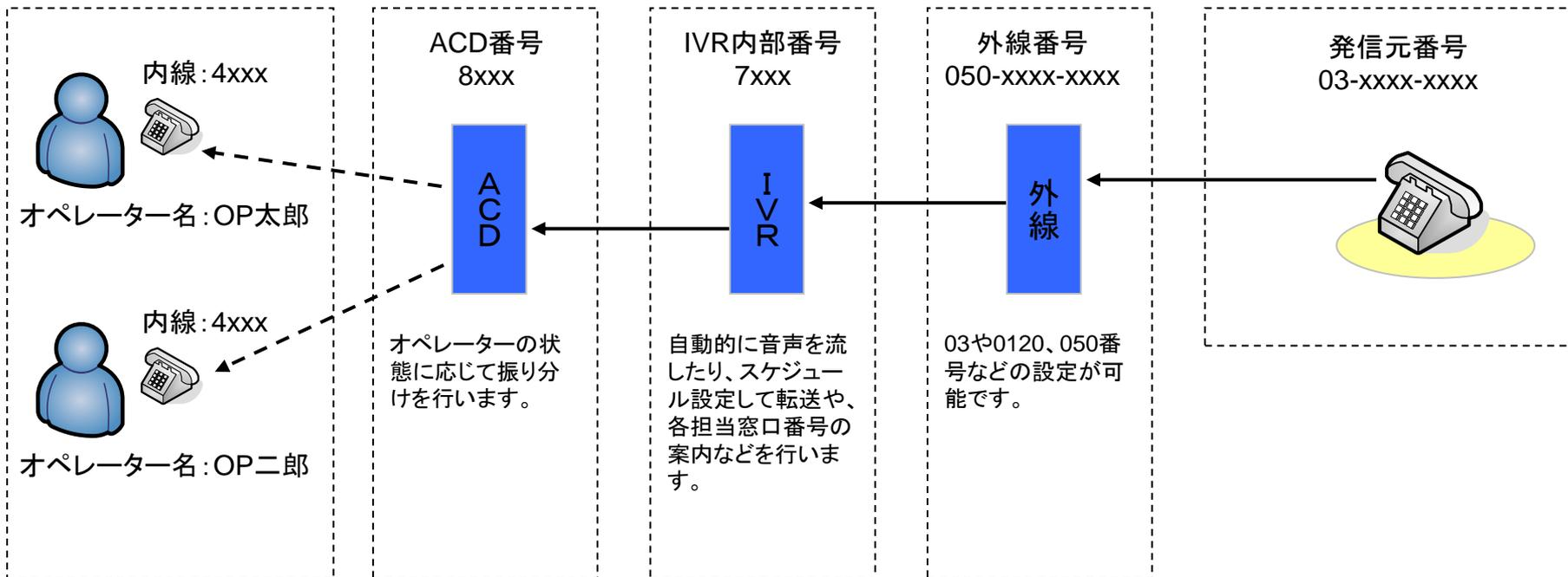
コールフローの構成機能として「外線」「IVR」「ACD」「内線」「オペレーター」があります。
